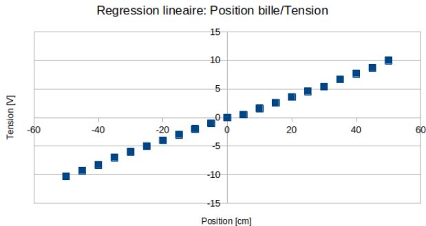
Figure 8 – Relation entre la position de la bille et la tension de sortie du système pour faire une régression linéaire
