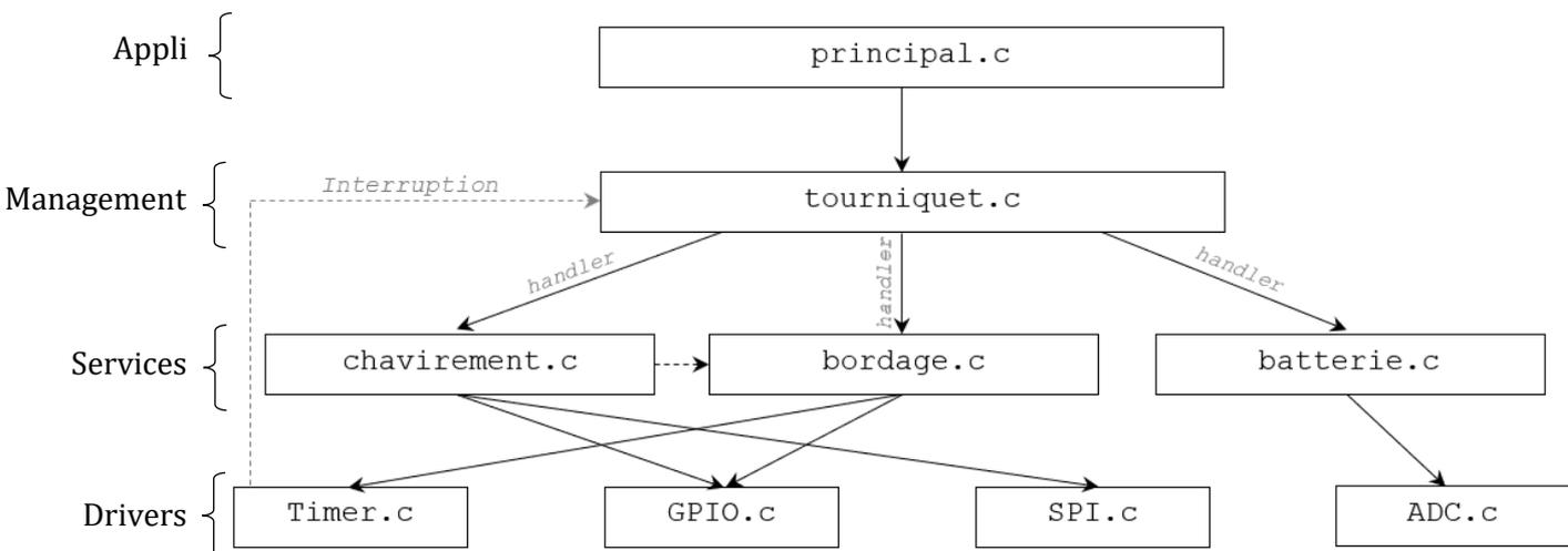
Figure 2 : architecture logicielle de l'exécution des fonctionnalités développées
