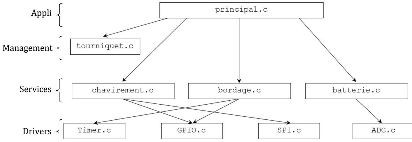
Figure 1 : architecture logicielle de l'initialisation des fonctionnalités développées
